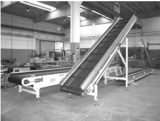
sponde, possibilità di motorizzare il nastro in testa oppure centralmente, possibilità di inserire cilindri motorizzati di diametro elevato o gommati per aumentare la capacità di trascinamento del NAU stesso.
